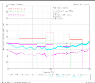
图 8-47. 传导 EMI 与 CISPR25 限值 (黄色: 峰值信号, 蓝色: 平均信号)
